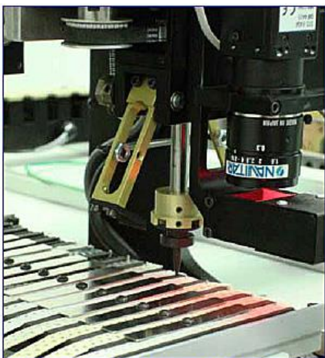
Obr.9: Nosná pracovní plocha s podavači součástek
