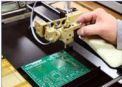
Obr. 1: Příklad manuální hlavy a podpěrky ruky
